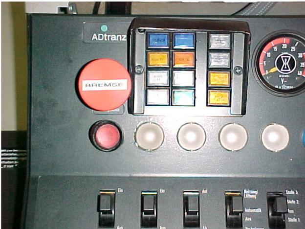
Bild 1: Aufsatz „Bremsse“ über Schlagschalter „Federspeicher“ setzen
