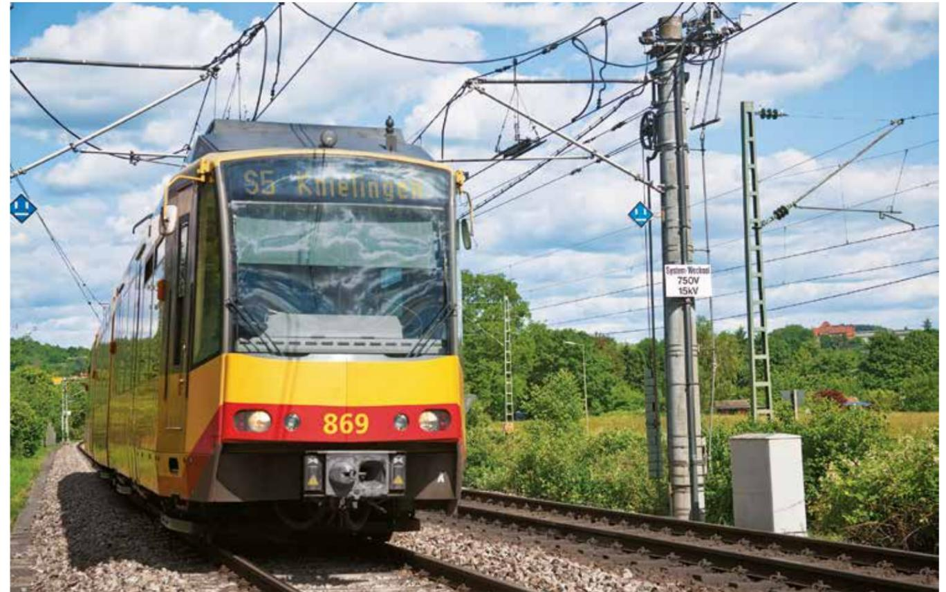
Die Systemwechselstelle ist notwendig, um der Stadtbahn den Übergang vom Eisenbahn- ins Straßenbahnnetz zu ermöglichen.
